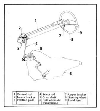
Fig. TM-7 Manual linkage
